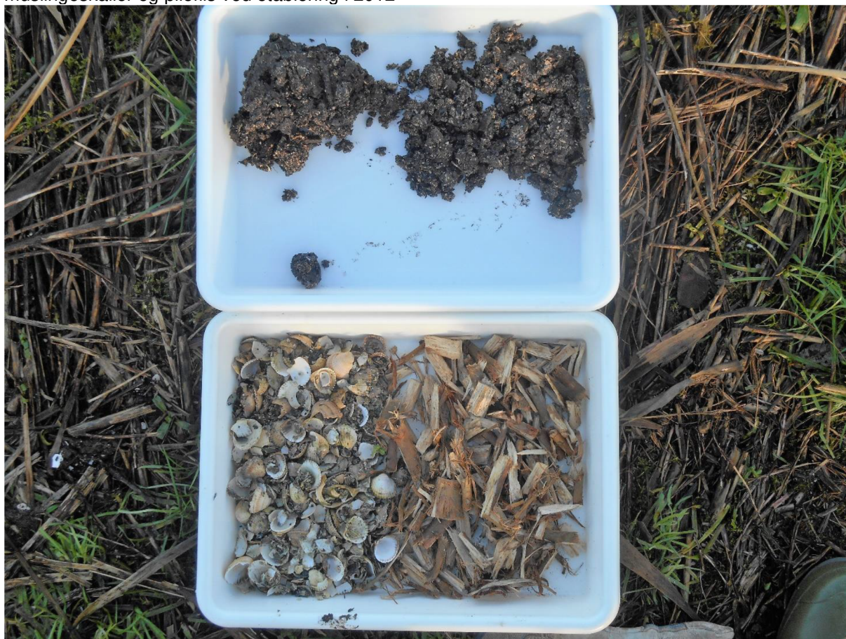
Figur 13.4 Fotoet viser: øverst matricens udseende november 2017 og nederst udgangsmaterialer muslingeskaller og pileflis ved etablering i 2012
