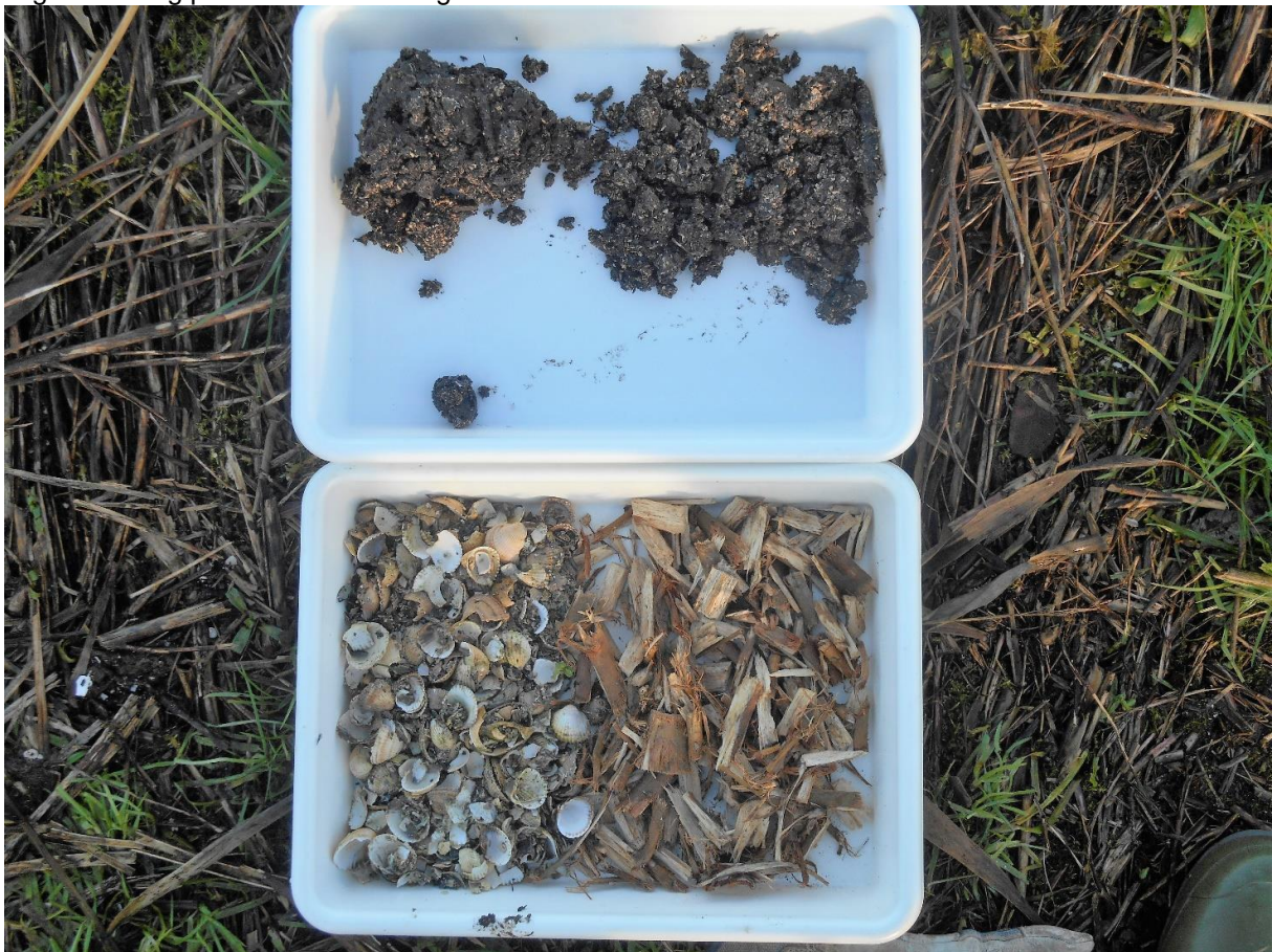
Figur 9 Fotoet viser: øverst matricens udseende november 2017 og nederst udgangsmaterialer muslingeskaller og pileflis ved etablering i 2012
