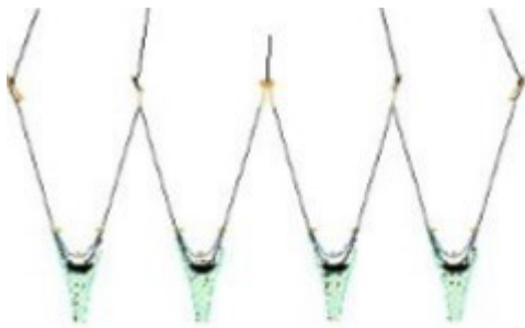
Fig. 2.1.5. Eksempel på multirigsystem, hvor der anvendes 4 trawl, der spredes med to sæt medskovle og en center klump. Denne rig slæbes i fem wirer.
